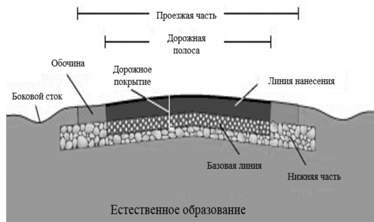
Рис. 1. Проектирование дорожной системы
